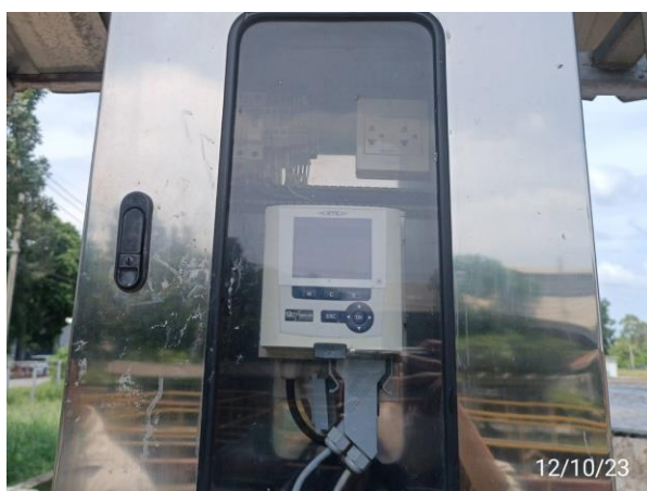
รูปที่ 9 อุปกรณ์ตรวจวัด COD Online บริเวณระบบบำบัดน้ำเสีย
